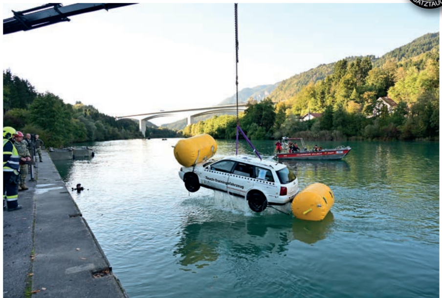
Nachdem die Taucher mit den Hebeballonen das Fahrzeug an die Oberfläche der Drau brachten, erfolgte die Bergung durch die Landmannschaft mit dem Rüstkran.
