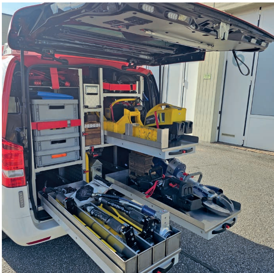
Im Heck sind einige Gerätesätze in Bezug auf die technische Hilfe bei Verkehrsunfällen untergebracht. In der Heckklappe sind Beleuchtungs- und Warneinrichtungen verbaut.
