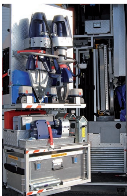
Der erste eDraulic-Satz in Kärnten im Geräteraum 2 des RTL3-A-6500-Tunnel.
